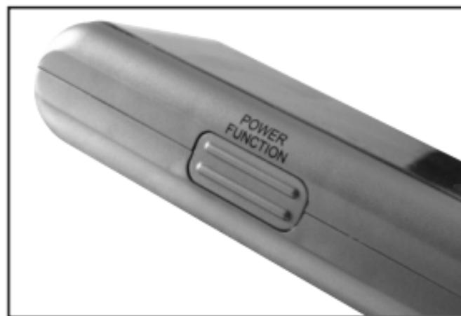
En este momento comenzará la calibración automática para la detección de metales, activándose las barras inferiores del indicador de exploración. Este procedimiento habrá finalizado cuando el indicador de exploración provea una breve indicación de fondo de escala y luego se apague totalmente. Al mismo tiempo, se mostrará el símbolo de exploración en la pantalla LCD y se escuchará un breve pitido. En ese momento el instrumento estará listo para comenzar la exploración.
